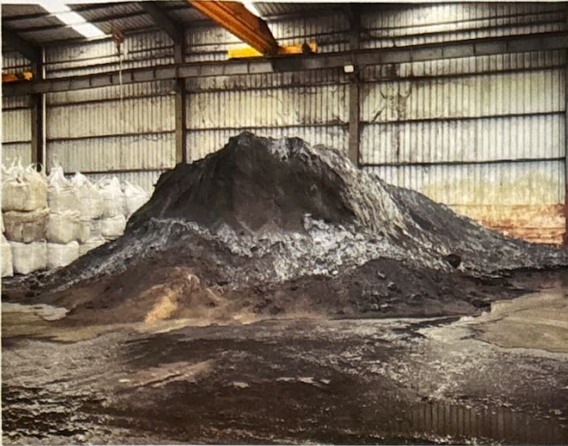
โรงงานฯ ใช้วัตถุดิบ คือ กากตะกอนทองแดงเป็นวัตถุดิบในกระบวนการหลอมโลหะมีค่า
