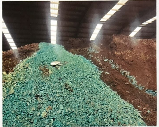
โรงงานฯ ใช้วัตถุดิบ คือ กากตะกอนทองแดงเป็นวัตถุดิบในกระบวนการหลอมโลหะมีค่า
