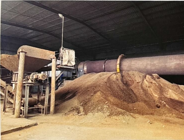
มีเตาอบแห้ง จำนวน ๑ ชุด ใช้ก๊าซธรรมชาติเป็นเชื้อเพลิง อากาศเสียจากเตาอบแห้งจะถูกรวบรวมเข้าสู่ระบบบำบัดมลพิษ ทางอากาศแบบถุงกรอง (Bag Filter)
